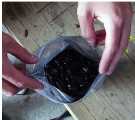
Vervuild hout dat na een thermolyse-behandeling omgevormd werd tot zuivere houtskool.
