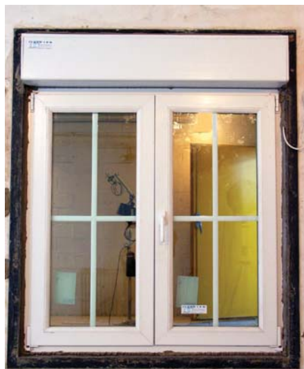
Afb. 2 Om een goede isolatie te bereiken, is het noodzakelijk om ook de rolluikkast zelf te behandelen.
