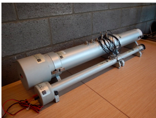
Afb. 1 Bepaling van de absorptiecoëfficiënt \alpha voor loodrechte inval in de buis van Kundt volgens NBN EN ISO 10534.
