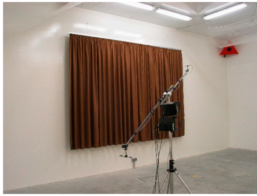
Afb. 2 Bepaling van de absorptiecoëfficiënt \alpha_s voor diffuse inval in de nagalmkamer volgens NBN EN ISO 354.
