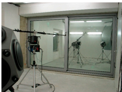
Afb. 1 Bepaling van de geluidsverzwakkingsindex R in het laboratorium volgens NBN EN ISO 10140-2.
