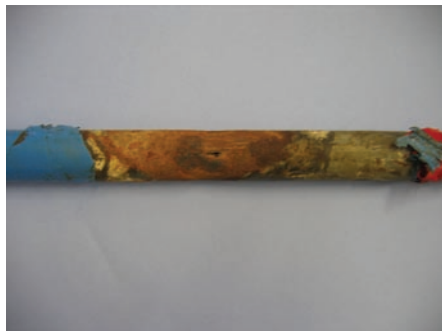
Afb. 3 Externe corrosie als gevolg van differentiële beluchting.
